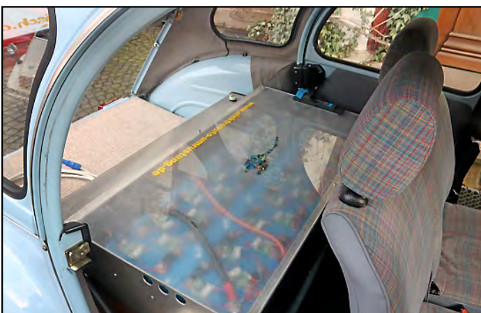
Beim Prototypen ist die Rücksitzbank den Batterien zum Opfer gefallen. Die Akkus können aber auch anders platziert werden.
